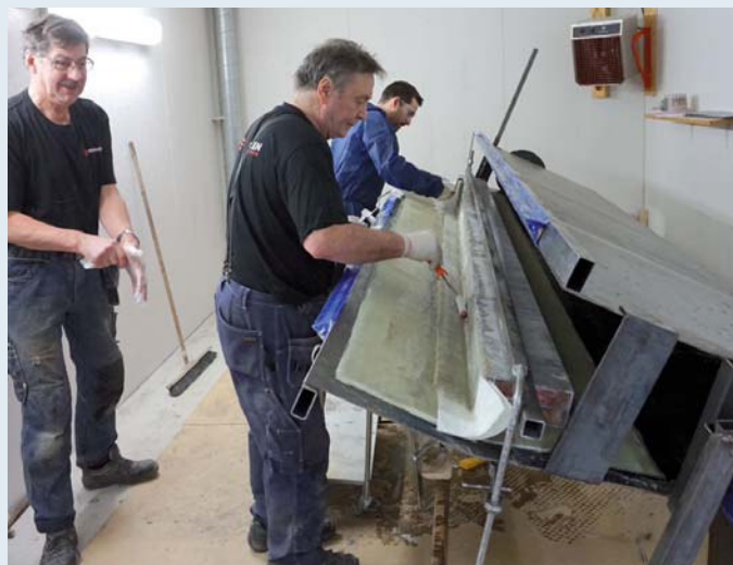
Handlaminieren eines Prototypteils
