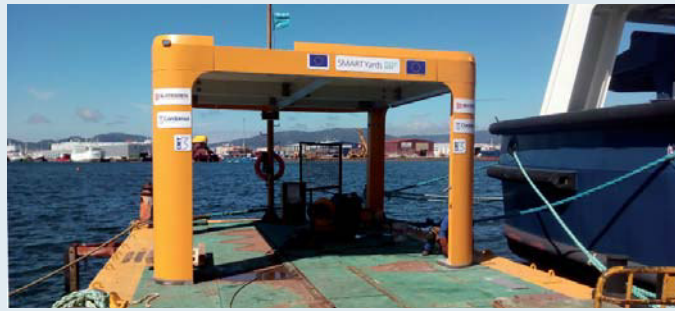
SMARTYards-Prototyp: ein aus verschiedenen FVB- und Stahlteilen hergestelltes Deck
